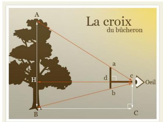
Lorsque les deux extrémités de l'arbre correspondent aux extrémités de la baguette verticale, mesurer la distance vous séparant de l'arbre ( $BC$ ). La hauteur de l'arbre ( $AB$ ) est alors égale à la distance ( $BC$ ).
